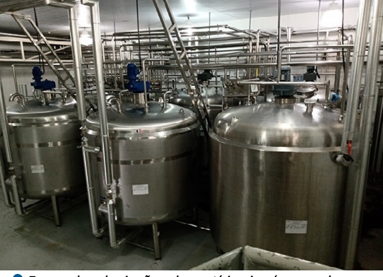
● Tanques de padronização onde a matéria prima é processada
